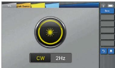
VFL ermöglicht das Auffinden direkter Fehlerstellen in toten Zonen von Fasertests oder das Durchführen einer Faserkernkalibrierung in Mehrfaserkabeln.
