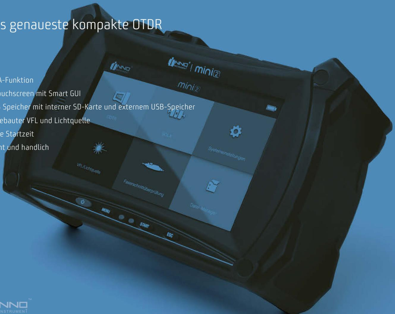
Der MINI 2 OTDR wird bei der Installation und Wartung von Glasfaserkabeln eingesetzt. Zu seinen Merkmalen gehören hochpräzise Testfunktionen, schnelle Reaktionszeiten und eine einfach zu erlernende Handhabung. Der kapazitive Mehrpunkt-Touchscreen ermöglicht eine benutzerfreundliche Bedienung.
