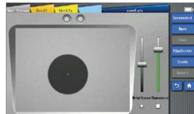
Der Faserendtester (Peripheriegerät erforderlich) wird hauptsächlich zum Testen der Sauberkeit und Ebenheit der Faserendfläche verwendet.
