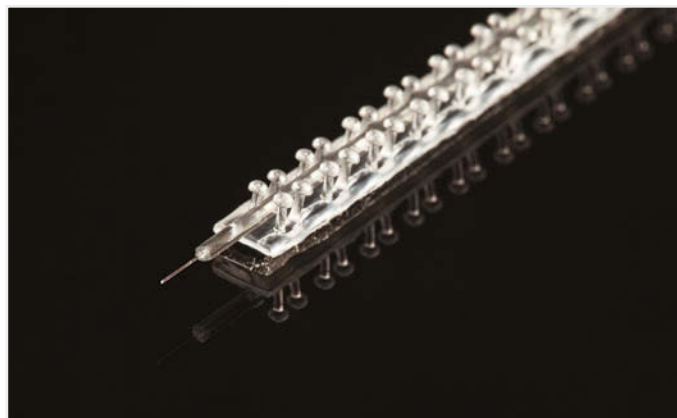
Abbildung 7. Detailansicht des transparenten Kanals. Die transparente Faser wird durch die pilzförmigen Elemente an ihrem Platz gehalten.
